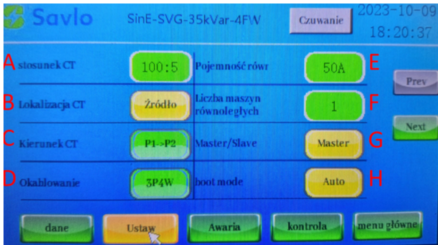
Rysunek 16. Ekran ustawień SVG - strona 1
